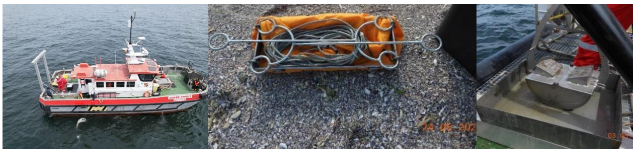
Figura IV.7 a. Ambarcațiune pentru deplasarea în punctele de colectare a probelor; b. Dragă, c. Van Veen (Sursa: Blumenfield 2023)
