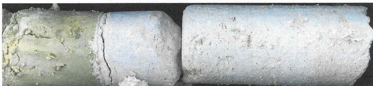
Figura 34. Zona de tranziție de la argile verzi la calcare organogene în forajul BN1 la 34,4m
