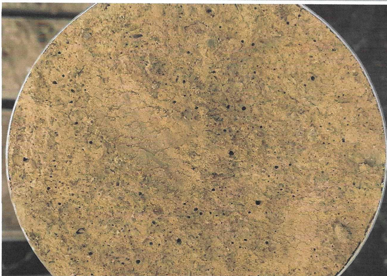
Figura 26. Structură macroporică în formațiunea de loess, orizont 1 – foraj BN2 la 6m, proba SH3B
