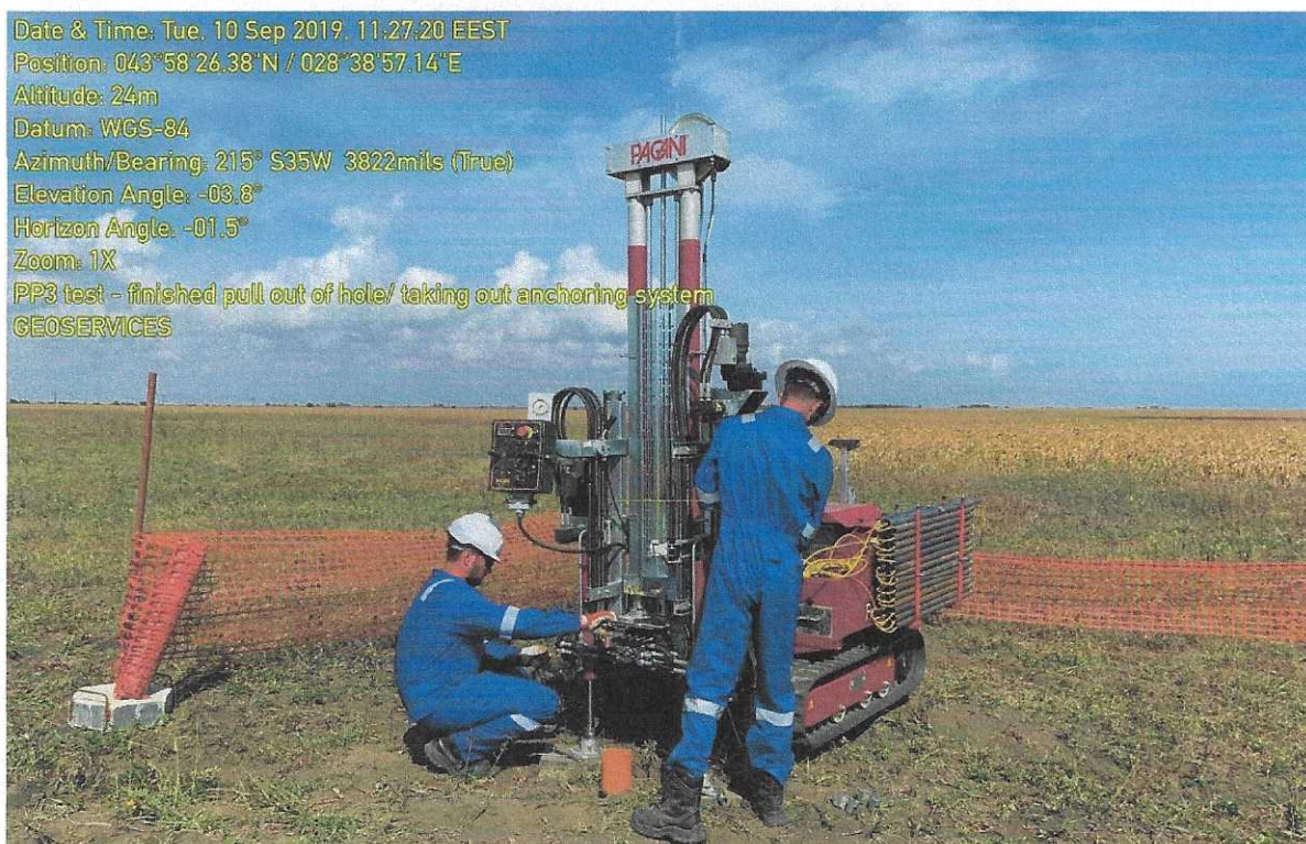
Figura 23. Efectuare test de penetrare cu piezocon - CPTu (locație test: PP3)
