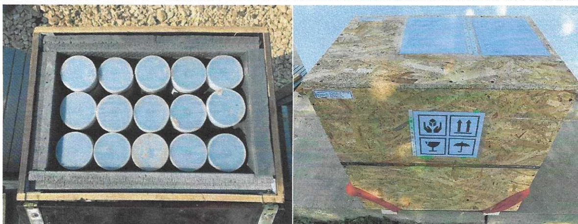
Figura 17. Gestionarea probelor și a eșantioanelor; depozitare probe Shelby și pregătirea pentru transport
