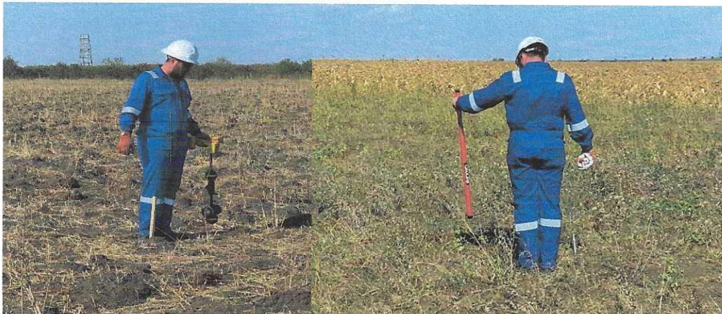
Figura 12. Detecție de utilități îngropate înainte de începerea lucrărilor (locator electromagnetic și sondaj magnetometru)
