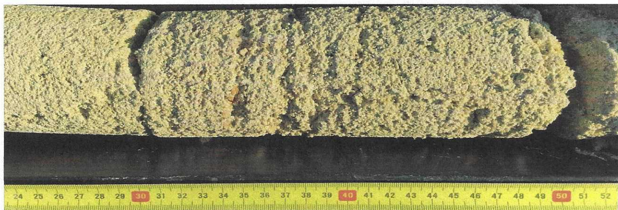
Figura 35. Calcar oolitic compact alternând cu intervale friabile în forajul BN1 la 39m
