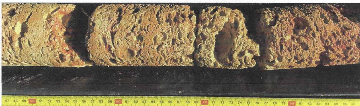
Figura 32. Calcar bioclastic cu macrofosile cu goluri de dizolvare, intervale afectate de oxidare în forajul BN1 la 24,5m
