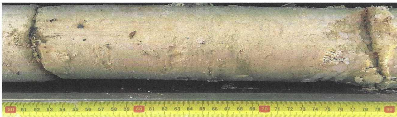
Figura 33. Calcar argilos cu intercalații de argile verzi-cenușii în forajul BN1, la 33,5m
