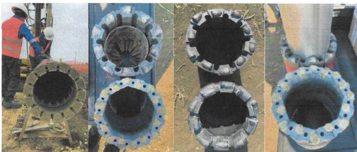
Figura 14. Tipuri de echipamente utilizate pentru carotaj și prelevare probe în formațiuni tari, calcare (freze, coroane)
