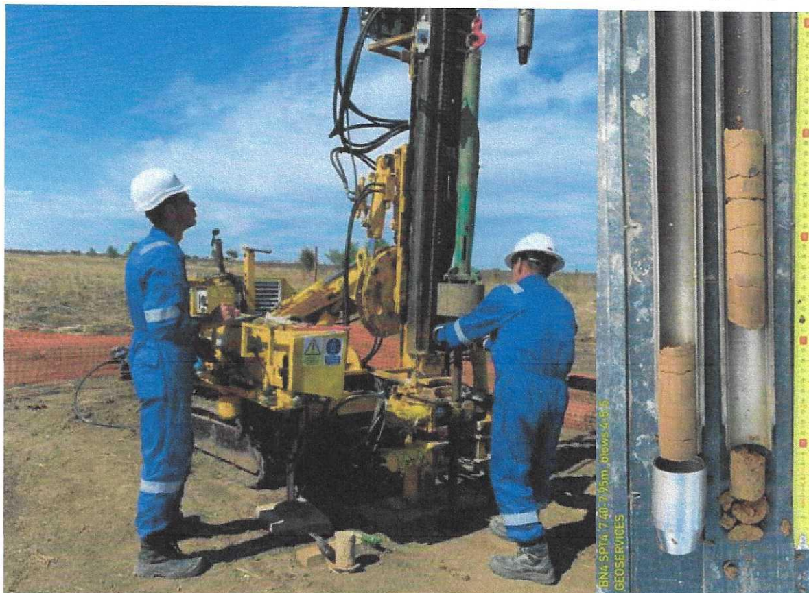
Figura 18. Test SPT, prelevare eșantioane cu ajutorul prelevatorului Raymond (tub "split barrel")
