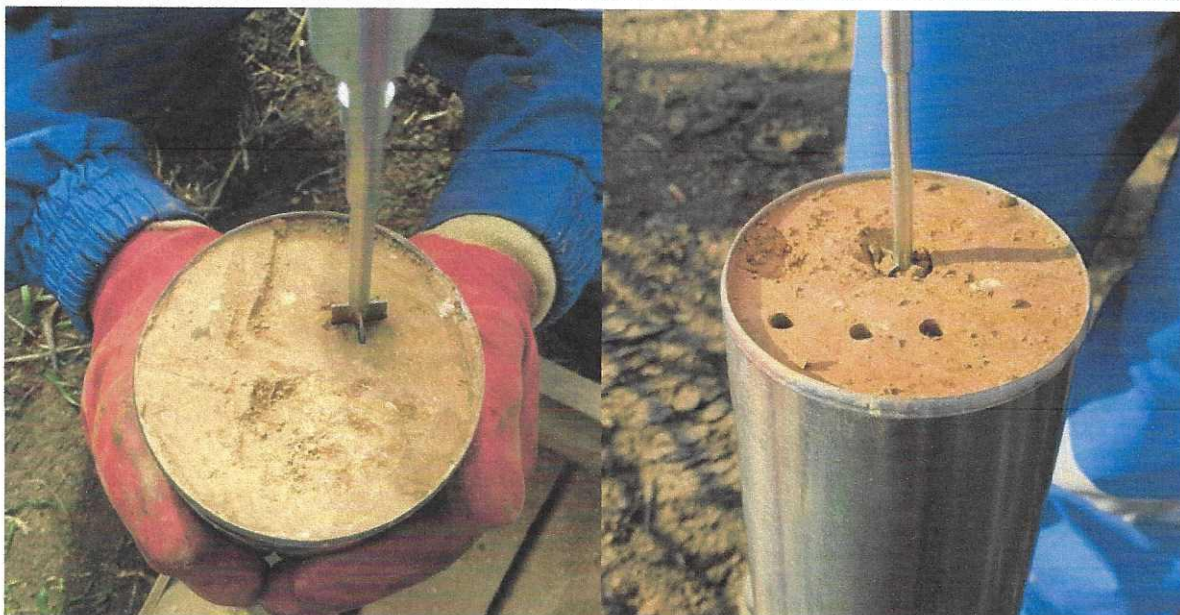
Figura 20. Efectuarea testului de forfecare cu palete, cu dispozitivul tip "Vane shear"
