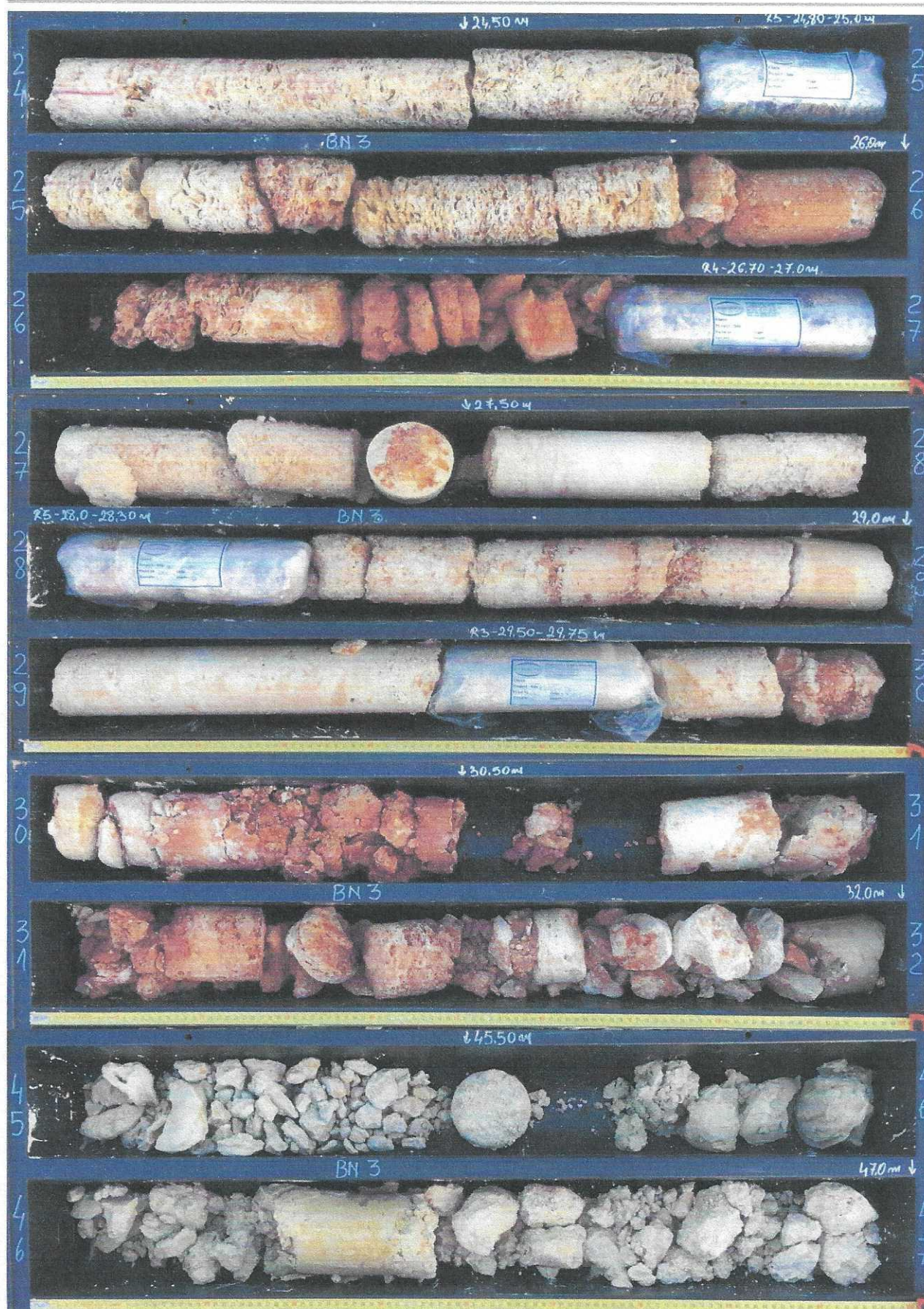
Figura 36. Procese de fragmentare, fisuri, goluri și fenomene de dizolvare asociate carstului în formațiunea de calcar în forajul BN3 pentru intervalul 21m – 47m CTN
