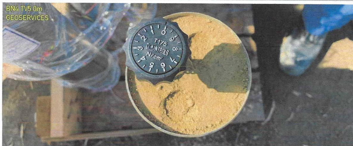
Figura 21. Testul de forfecare cu palete cu aparatul portabil (torvane) pe probe netulburate
