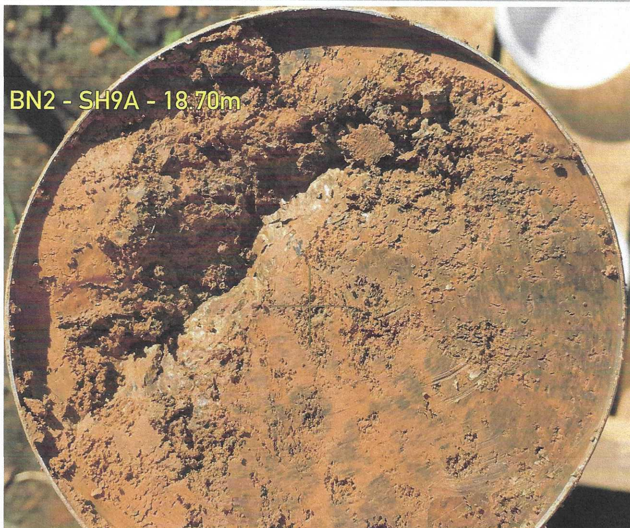
Figura 29. Argilă brună, brun-roșcată tare, friabilă, fisurată, cu înclinări de 45°, cu suprafețe lucioase de desprindere (oglinzi de fricțiune) în BN2, la 18,7m
