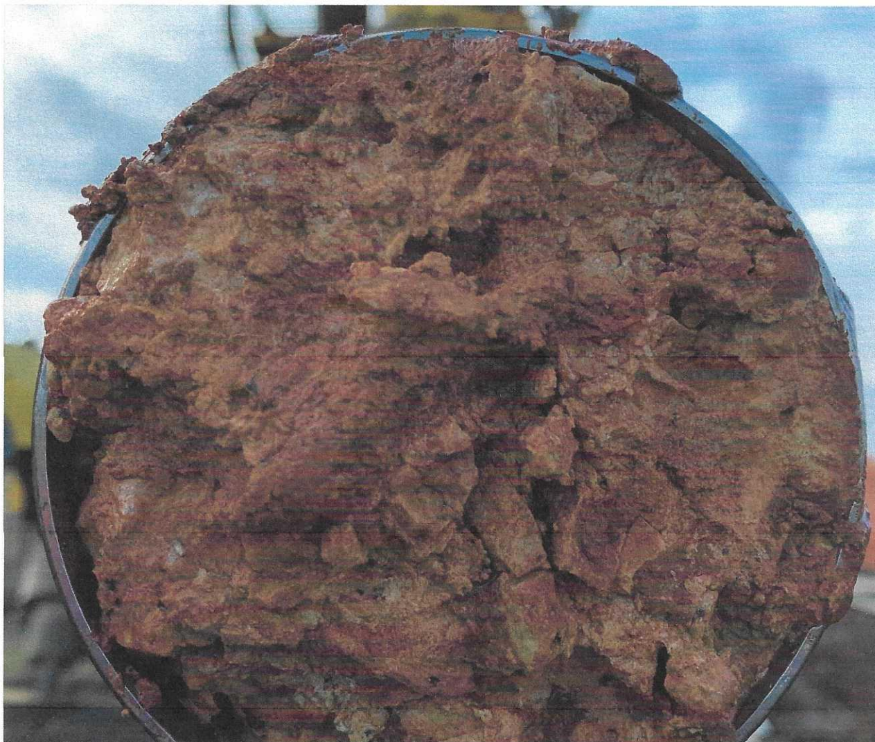
Figura 30. Argilă roșie (reziduală) cu fragmente angulare de calcar, zona alterată de tranziție în forajul BN4 la 20,25m
