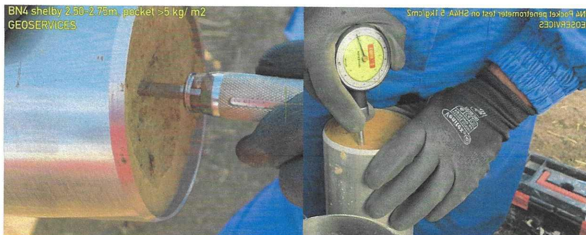
Figura 19. Încercări de penetrare cu penetrometrul de buzunar pe probe netulburate
