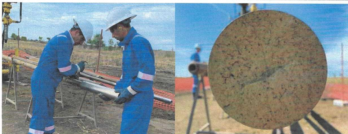
Figura 15. Activitate de prelevare probe netulburate – prelevare probă din formațiunea de loess (Shelby 101.6mm)
