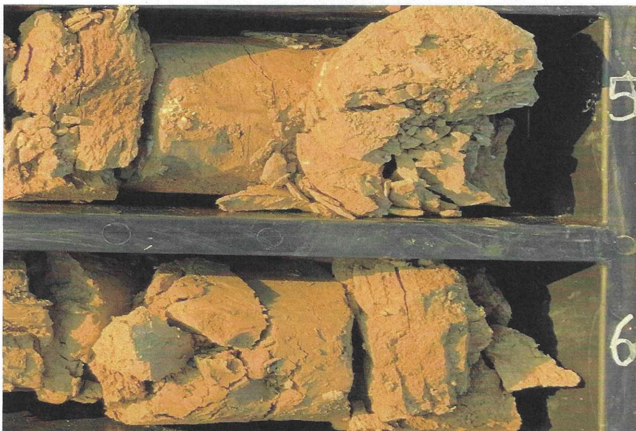
Figura 27. Loess friabil, uscat – subunitatea loess superior orizont 1, foraj BN,3 adâncimea 5m și 6m
