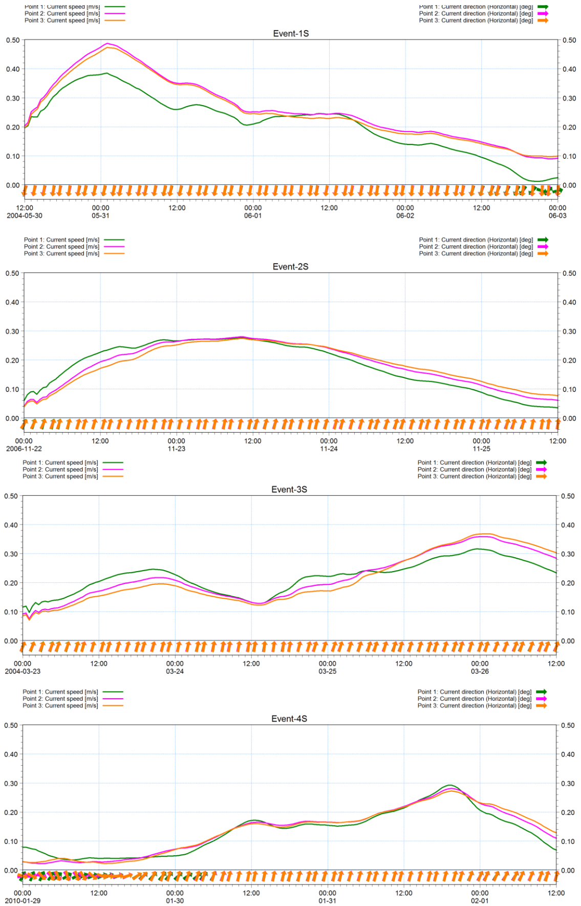
Figura 4-3. Serii de timp cu viteza și direcția curentului modelate la cele trei locații pe durata tuturor celor patru evenimente scurte.
