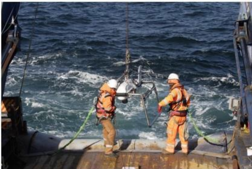
Figura 87 - Lansarea camerei STR.
