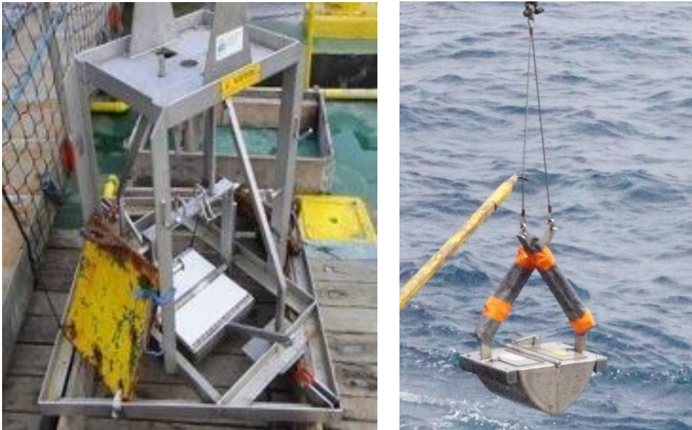
Figura 68 - Echipamentele de prelevare de tip Smith-McIntyre și Van Veen
