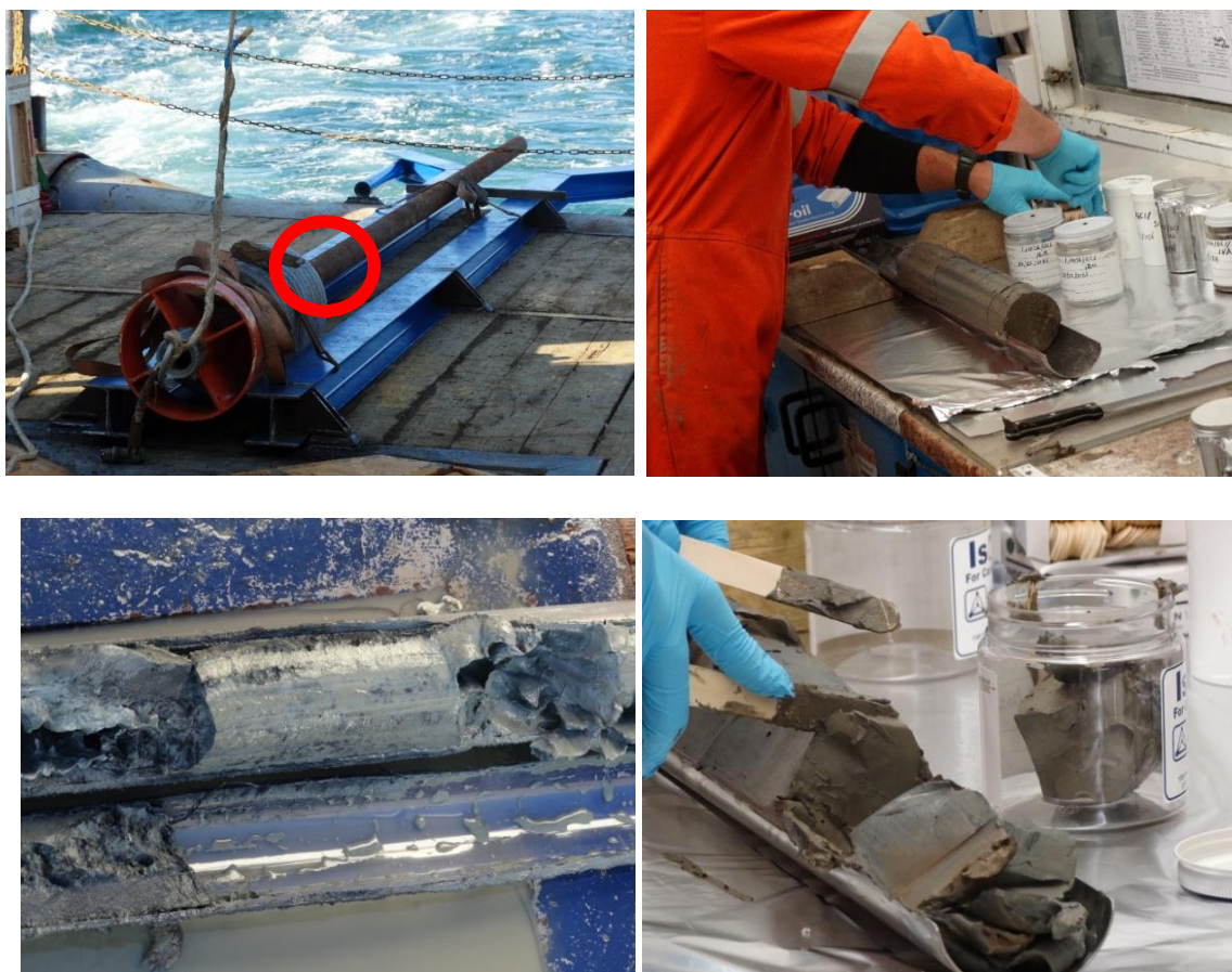
Fig. 4.5 Prelevarea și esantionarea probelor de sediment marin (foto orig. Blumenfield SRL)
