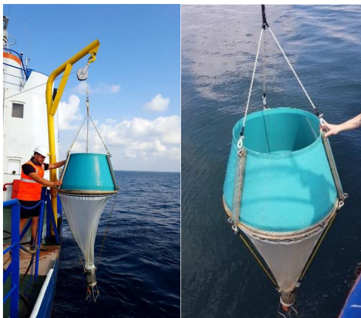
Figura 1.2.2-10. Fileul Hansen pentru prelevarea probelor de macrozooplancton
