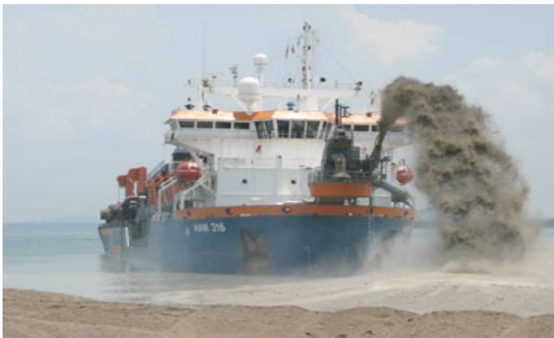
Draga TSHD HAM 316 în timpul operațiunii de pompare la distanță ( rainbow )
