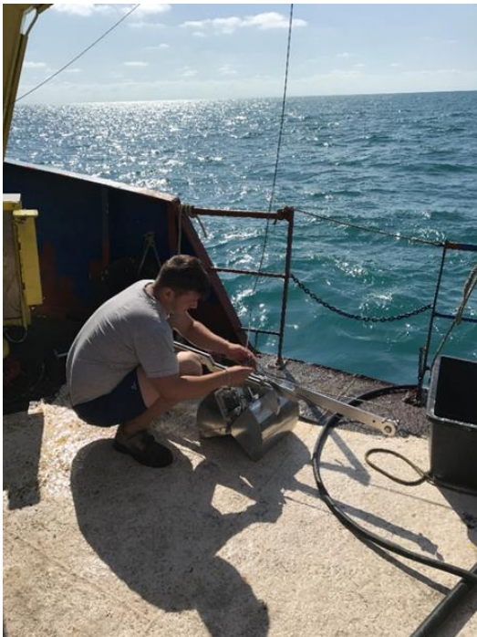
Foto 1 - Pregătirea bodengreiferului pentru prelevare
