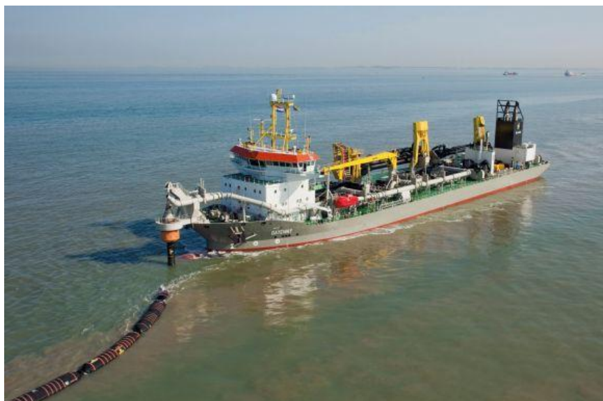
Fig. 4 – Pompare la tarm prin conducta (www.boskalis.com)
