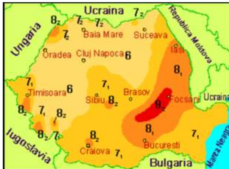
Figura 4-9: Zonarea seismica a Romaniei
