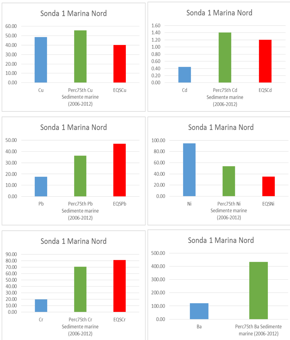
Figura nr. 7.34. Concentrațiile metalelor grele în sedimentele marine din zona de studiu în iunie 2016 în comparație cu valorile predominante ce caracterizează sedimentele de la litoralul românesc (2006-2012) și cu standardele de calitate pentru sedimente
