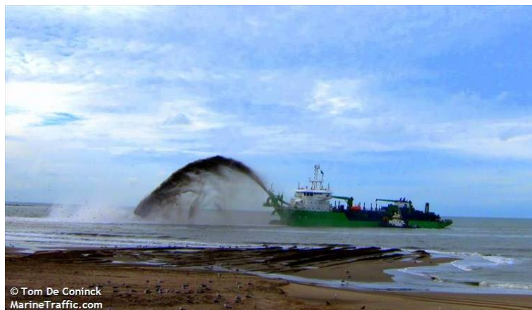
Pompare la distanta – rainbow cu draga tip BREUGHEL
