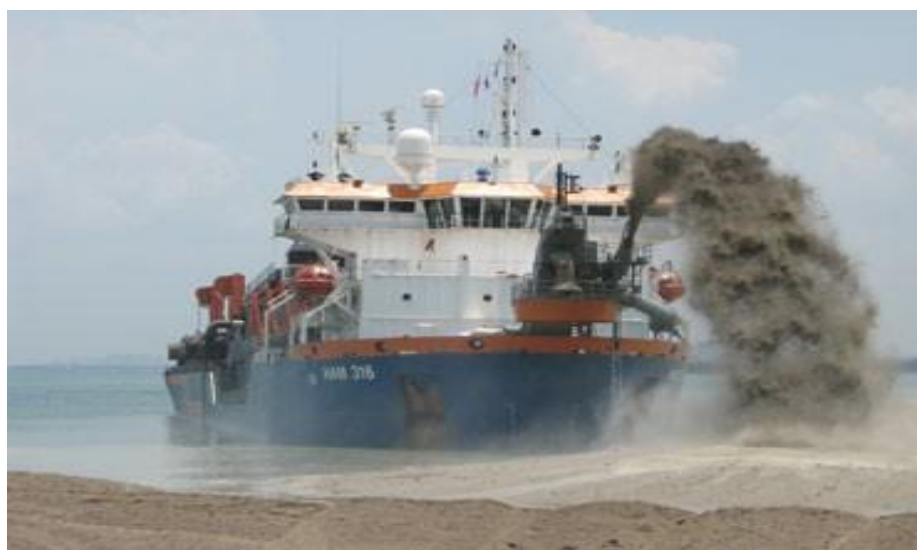
Figura 17 – Draga TSHD HAM 316 în timpul operațiunii de pompare la distanță (rainbow)
