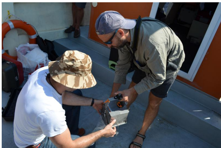
Figura 32- Prelevarea probelor din draga in pungi de probe
