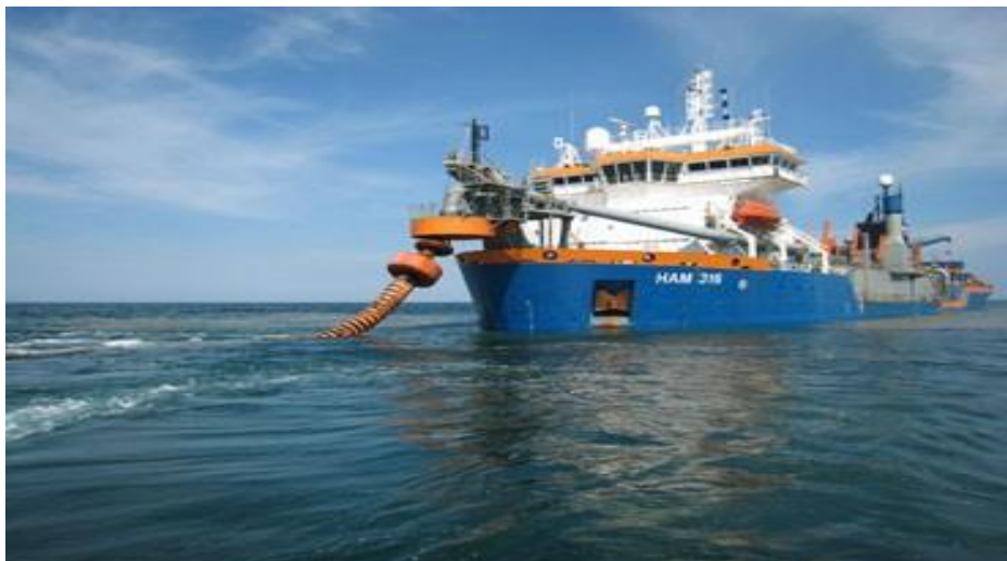
Figura 18 – Draga TSHD HAM 316 in timpul operatiunii de pompare la tarm prin conducte
