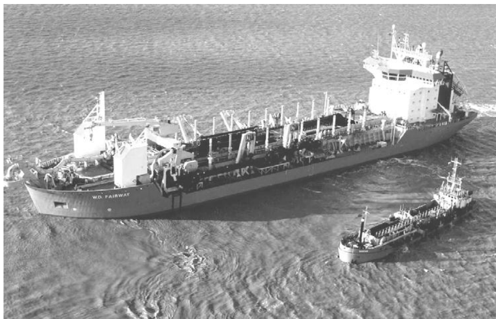
Figura 9 – Dragi TSHD de 23350 respectiv 700 mc (dupa Vlasblom, 2003)
