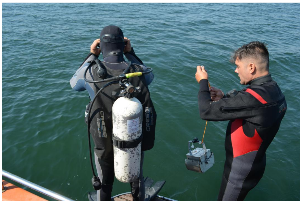
Figura 30- Draga tip Bodengreifer (pregătirea înaintea scufundării)
