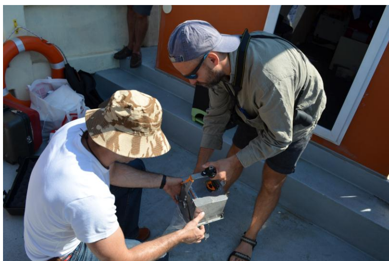
Figura 33- Prelevarea probelor din draga in pungi de probe
