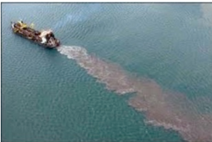
Pată de sediment în urma unei drăgi TSHD ( www.turbidity-measurement.org )
