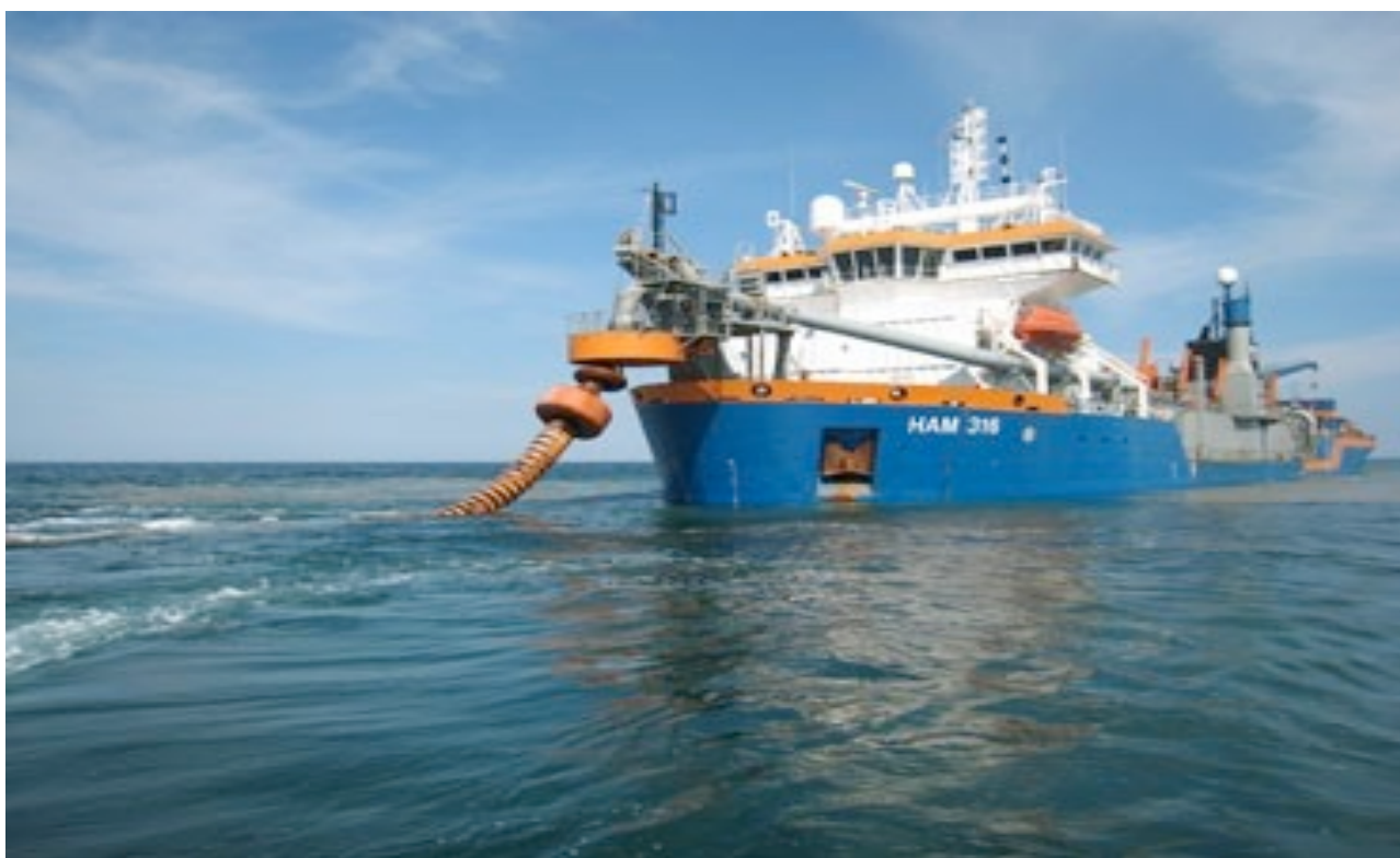
Draga TSHD HAM 316 în timpul operațiunii de pompăre la țărm prin conducte ( https://www.dredgepoint.org/dredging-database/equipment/ham-316 )
