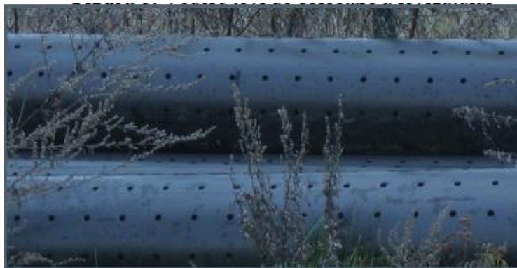
Fig.4 - Tevi riflante pentru rețeaua de drenaj
