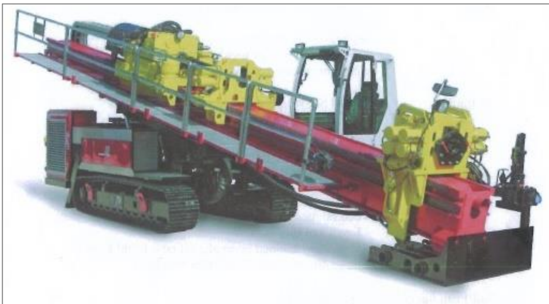
Figura 5: Instalație de foraj orizontal dirijat
