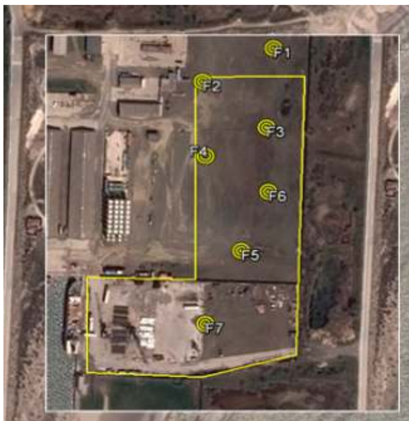
Figura 4.4-3: Amplasarea forajelor geotehnice pe amplasament
