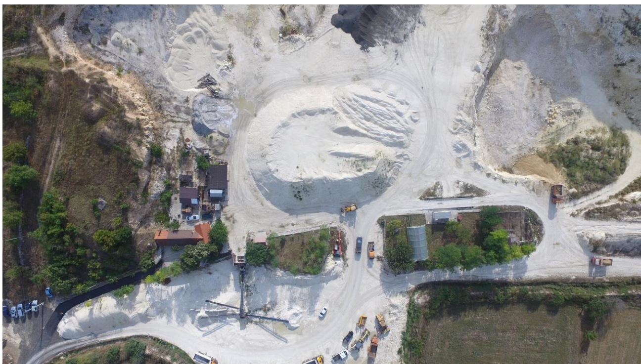
Figura 17. Imagine de ansamblu asupra vetrei de carieră la nivelul căreia se disting: zona organizării de șantier, stația de concasare/sortare, conurile de depozitare a sorturilor obținute, utilajele de lucru
