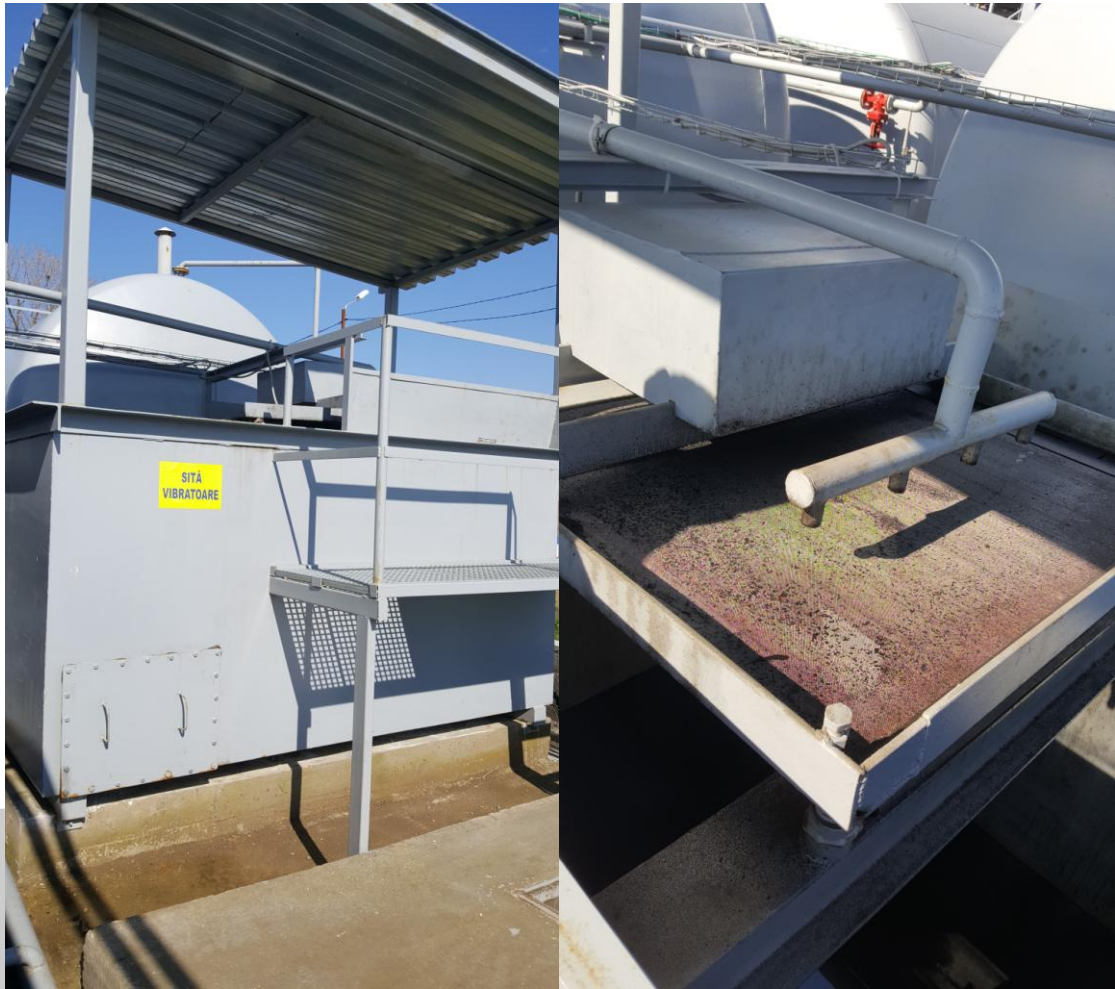
Foto 16. Sita vibratoare pentru separarea impuritatilor mecanice
