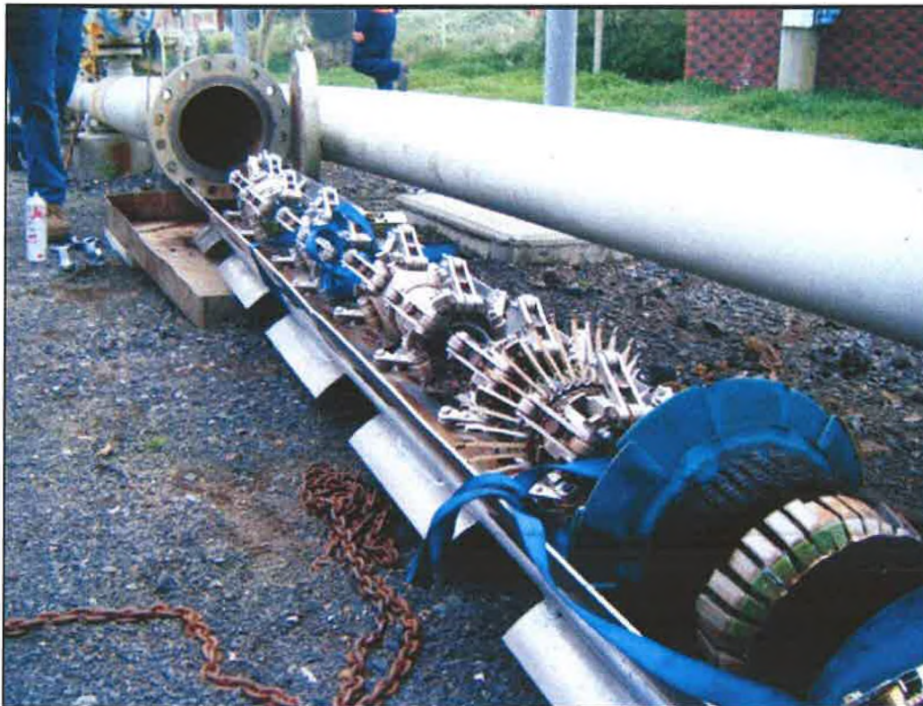
Imagine 6. Dispozitiv inspecție și curățare (Godevil)
