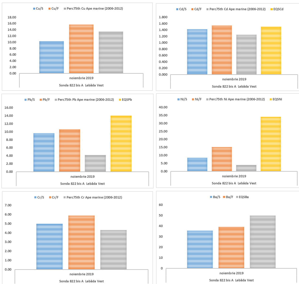
Figura nr. 2.30. Concentrațiile metalelor grele (µg/L) în apele marine din zona de studiu în noiembrie 2019, comparate cu percentila 75th a datelor de monitoring, perioada 2006-2012 si cu valorile standardelor de mediu (EQS)
