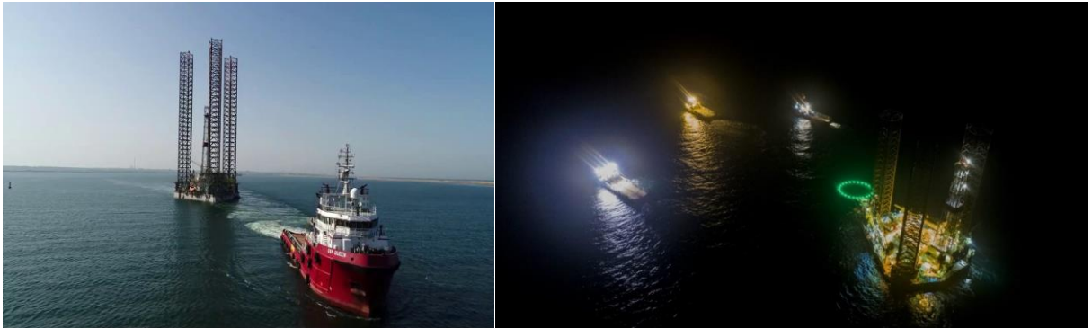
Figura nr. 1.6. Operațiuni specifice de tractare a platformei Uranus
