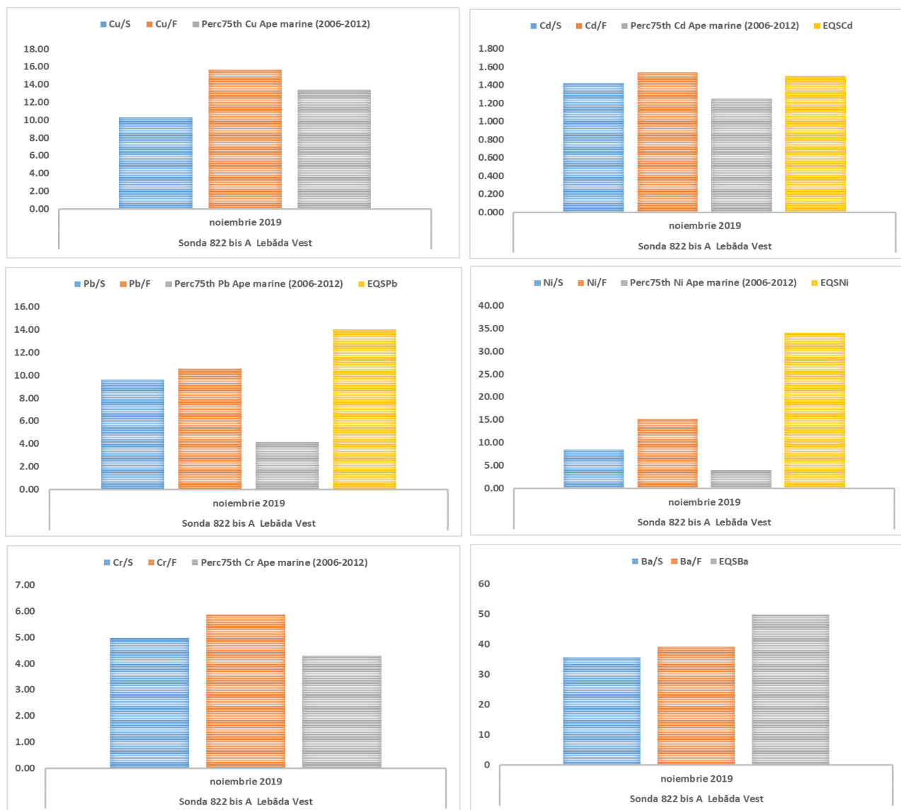
Figura nr. 3.30. Concentrațiile metalelor grele ( \mu\text{g/L} ) în apele marine din zona de studiu în noiembrie 2019, comparate cu percentila 75th a datelor de monitoring, perioada 2006-2012 și cu valorile standardelor de mediu (EQS)
