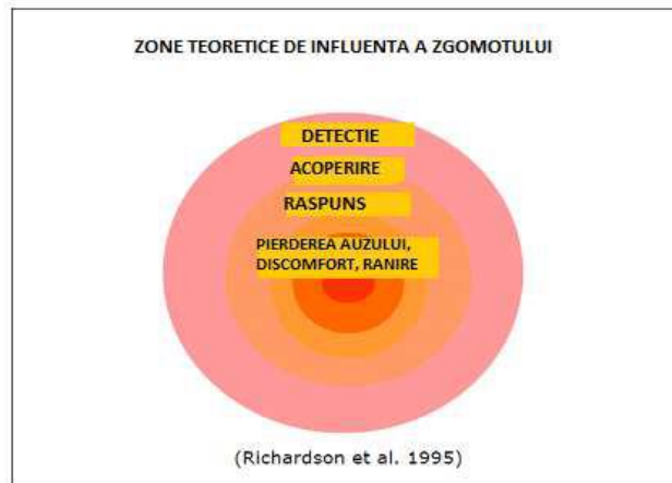
Figura nr. 5.4. Zone teoretice de influență a zgomotului asupra mamiferelor marine (adaptare după Richardson et al., 1995)
