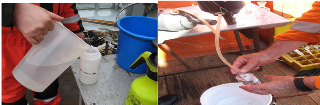
Figura nr. 3. 4. Prelevarea și păstrarea probelor din coloana de apă
