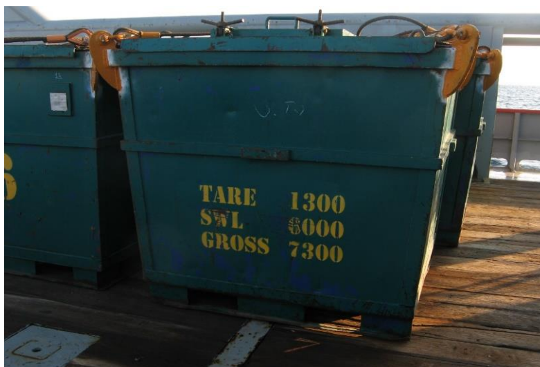
Figura nr. 1.11. Cutii speciale (Skips) pentru transportul detritusului la țărm
