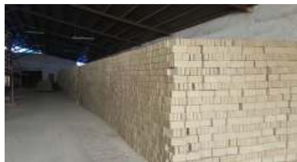
Fabrica este dotata si cu o uscatorie unde se foloseste procedeu de uscare artificiala. Uscatoria este prevazuta cu patrutele de uscare in care sunt introdusi vagoneti prin intermediul cailor speciale de rulare. In fiecare tunel incap 25 de vagoneti, iar in fiecare vagonet sunt incarcate 100 caramizi. In uscatoria artificiala (foto jos) este folosita caldura gazelor de ardere provenite de la cuptorul Hoffmann.
