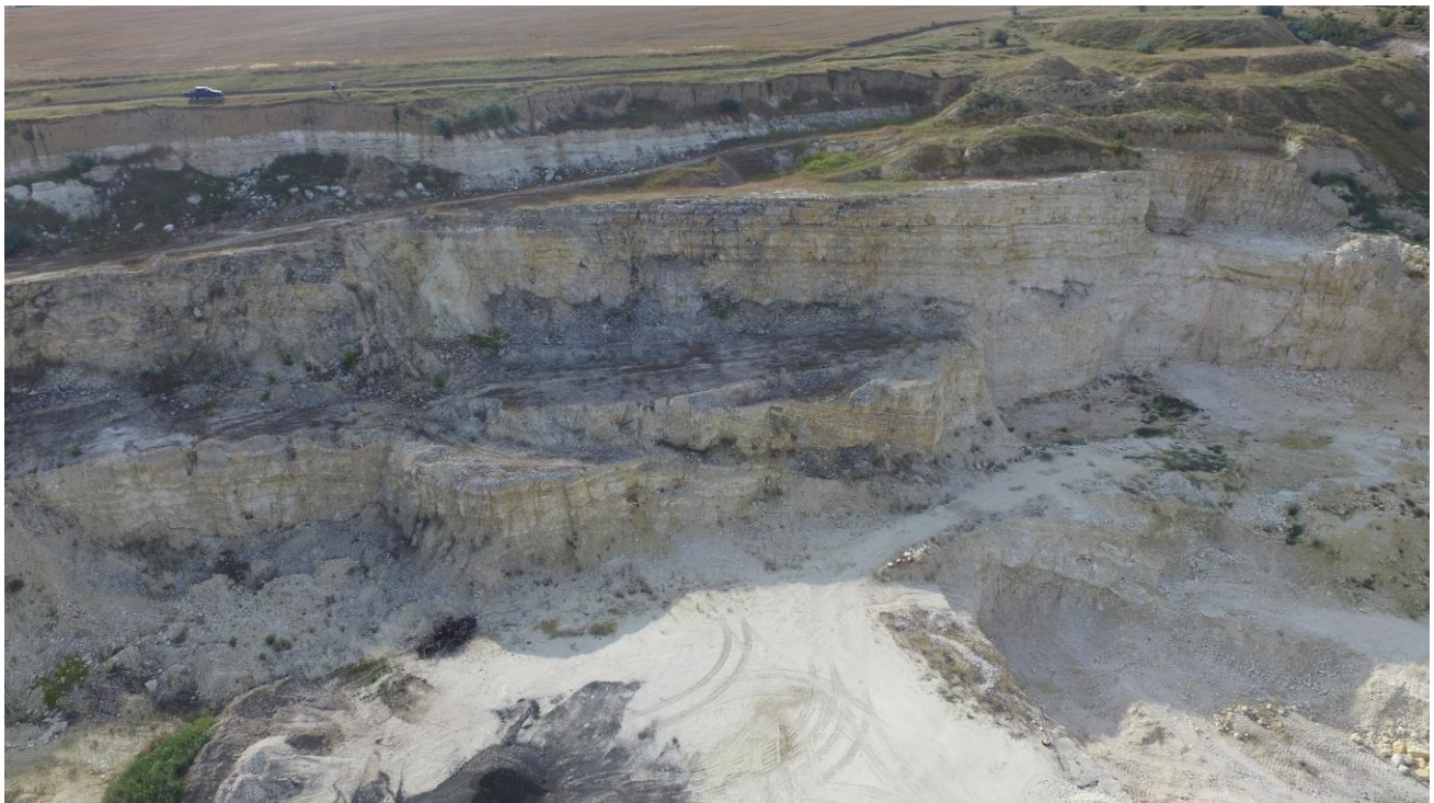
Figura 5. Profilul actual al carierei – zona estică : se observă morfologia treptelor ce au făcut obiectul exploatării în cadrul unor etape anterioare; se observă de asemenea profilul copertei și a rocii dezagregate amestecate cu copertă, ce participă la generarea volumelor de sterile
