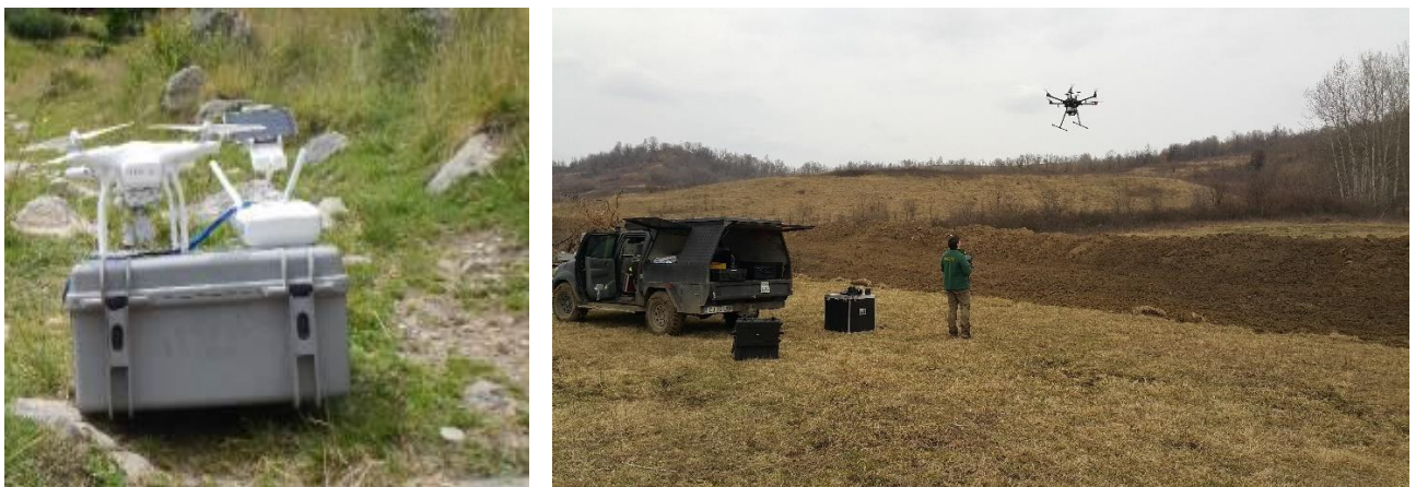
Figura 92. Drona DJI Phantom III-Advanced pregătită de zbor (stânga); Dronă DJI Matrice 600 PRO cu unitate LiDAR
