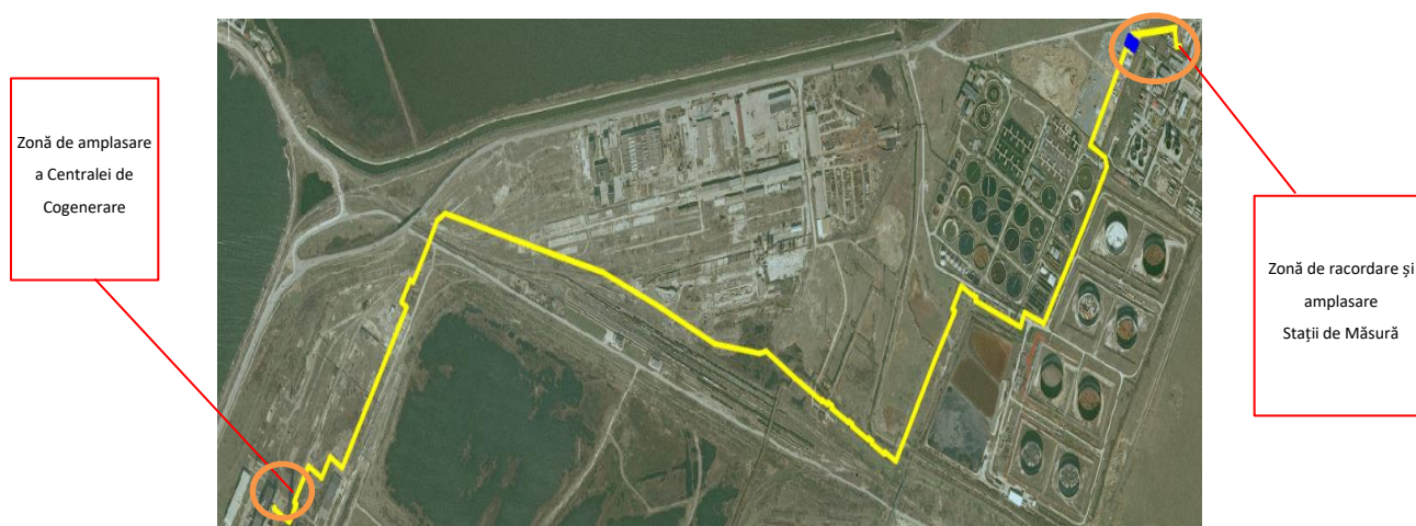
Fig. 1 – Amplasare conductă gaz natural
