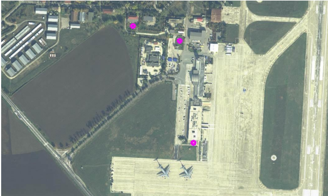
Pozitionarea rezervoarelor in cadrul aeroportului
