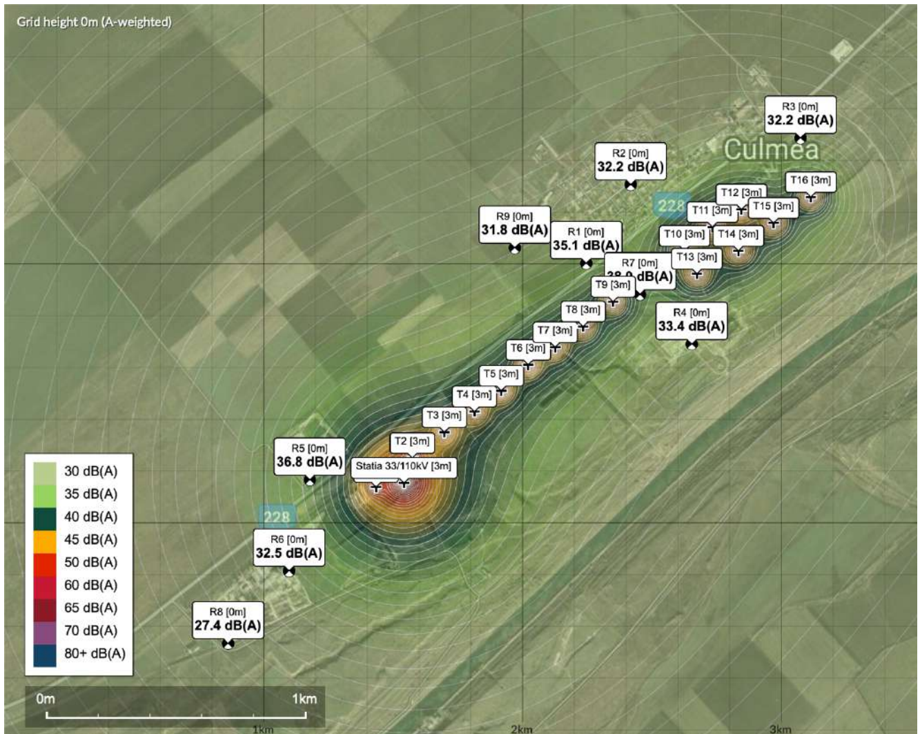
Figura nr. 7-3 Modelare zgomot etapa de functionare pe timpul zilei cu cele 16 posturi trafo active si Statia 110/33kV
