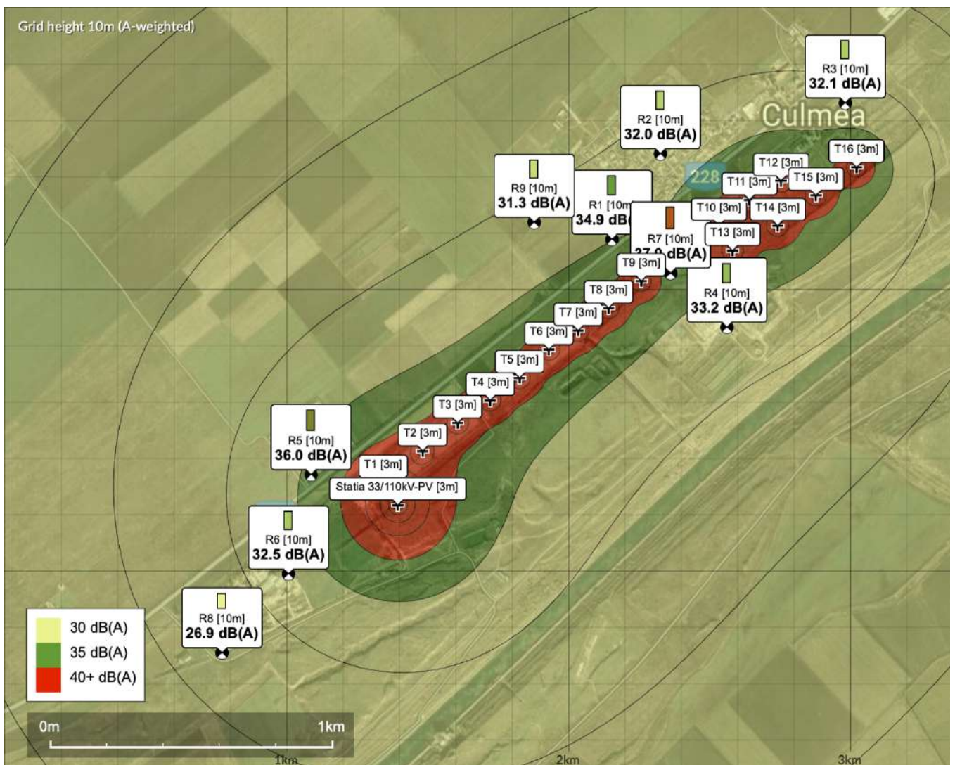
Figura nr. 7-7 Modelare zgomot etapa de functionare pe timpul noptii- la lasarea intinericului cu cele 16 posturi trafo active si Statia 110/33kV
