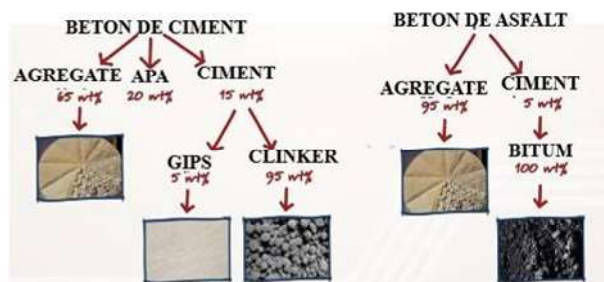
Comparatie a cantitatilor aproximative ale ingredientelor pentru obtinerea de beton asfaltic si beton de ciment
