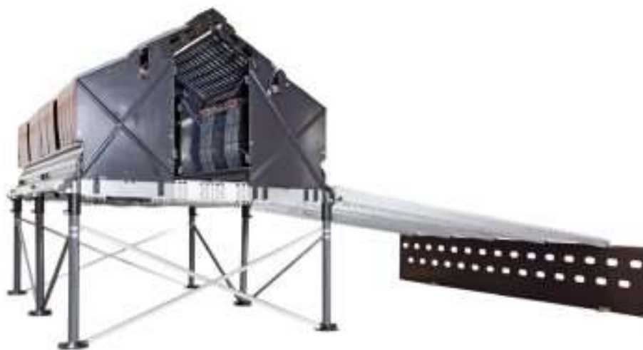
Fig.5 – Cuibar și podea cu grilaj atasată
