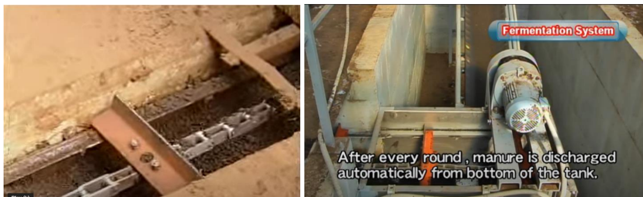
Fig.6 - Sistem de extractie cu lant si racleti
